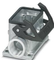
Embase en saillie B6, avec étrier longitudinal, matériau: Aluminium coulé sous pression, résistant à l'eau de mer, nombre de sorties: 2, latérale, 2x M20, hauteur: 54,6 mm, presse-étoupe: sans, Standard
