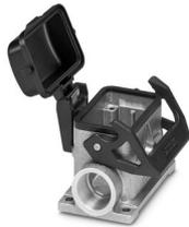
Embase en saillie B6, avec étrier longitudinal, matériau: Aluminium coulé sous pression, résistant à l'eau de mer, matériau du couvercle de protection: PC, nombre de sorties: 2, latérale, 2x M25, hauteur: 54,6 mm, presse-étoupe: sans, capot de protection: oui, Standard
