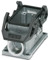
Embase en saillie B10, avec étrier transversal, matériau: Aluminium coulé sous pression, résistant à l'eau de mer, nombre de sorties: 2, latérale, 2x M20, hauteur: 54 mm, presse-étoupe: sans, Standard
