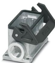
Embase en saillie B10, avec étrier longitudinal, matériau: Aluminium coulé sous pression, résistant à l'eau de mer, nombre de sorties: 2, latérale, 2x M20, hauteur: 54,6 mm, presse-étoupe: sans, Standard
