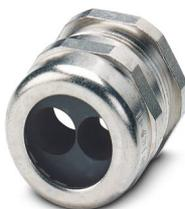
Presse-étoupe spécial M25, laiton nickelé, joint avec un diamètre de 10 mm et 11 mm
