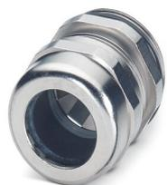
Presse-étoupe, matériau du raccordement vissé: Laiton, nickelé, diamètre extérieur du câble 11 mm ... 16 mm, blindage: oui, filetage de raccordement: M25 x 1,5, coloris: argenté, avec joint torique
