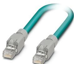
Câble Ethernet préconfectionné, blindé, à 4 paires, AWG 26 compatible avec les chaînes porte-câbles (19 fils), RAL 5021 (bleu d'eau), connecteur mâle RJ45/IP20 sur connecteur mâle RJ45/IP20, longueur 2 m
