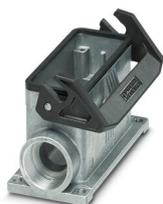
Embase en saillie B16, avec étrier longitudinal, matériau: Aluminium coulé sous pression, résistant à l'eau de mer, nombre de sorties: 2, latérale, 2x Pg21, hauteur: 68 mm, presse-étoupe: sans, Standard
