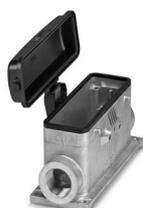
Embase en saillie B24, pour étrier transversal, matériau: Aluminium coulé sous pression, résistant à l'eau de mer, matériau du couvercle de protection: PC, nombre de sorties: 2, latérale, 2x M32, hauteur: 68 mm, presse-étoupe: sans, capot de protection: oui, Standard
