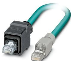
Câble Ethernet préconfectionné, blindé, à 4 paires, AWG 26 compatible avec les chaînes porte-câbles (19 fils), RAL 5021 (bleu d'eau), connecteur mâle RJ45/IP67 sur connecteur mâle RJ45/IP20 boîtier plastique Push-Pull, Line, longueur 2 m
