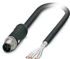
Câble pour capteurs/actionneurs, 5-pôles exempt d'halogène, blindé, connecteur mâle droit M12, détrompage: A SPEEDCONNEC, sur extrémité libre, longueur de câble: 0,5 m, pour application ferroviaires
