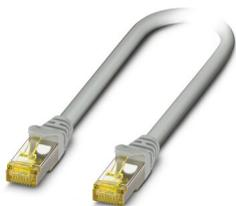
Câble de jonction, indice de protection: IP20, longueur de câble: 20 m, nombre de pôles: 8, 10 Gbit/s, CAT6<sub>A</sub>, type de raccordement: Raccordement Pierce, section raccordable: AWG 26- 26, sortie du câble: droit, Ethernet
