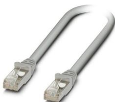
Câble de jonction, indice de protection: IP20, longueur de câble: 2 m, nombre de pôles: 8, CAT5, type de raccordement: Raccordement Pierce, section raccordable: AWG 26- 26, sortie du câble: droit, Ethernet
