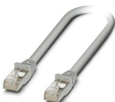
Câble de jonction, indice de protection: IP20, longueur de câble: 0,3 m, nombre de pôles: 8, CAT5, type de raccordement: Raccordement Pierce, section raccordable: AWG 26- 26, sortie du câble: droit, Ethernet
