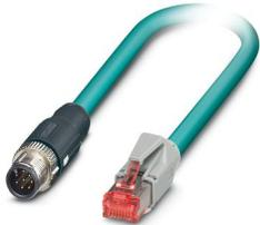
Câble de réseau, Ethernet CAT5 (1 Gbit/s), 8-pôles exempt d'halogène, blindé, connecteur mâle droit M12 SPEEDCONNEC, détrompage: A / IP67, sur connecteur mâle droit RJ45 / IP20, longueur de câble: 3 m, Protection spéciale
