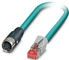
Câble de réseau, Ethernet CAT5 (1 Gbit/s), 8-pôles, Type de câble variable, blindé, Connecteur femelle droit M12 SPEEDCONNec, détrompage: A / IP67, sur connecteur mâle droit RJ45 / IP20, longueur de câble: Longueur au choix (0,2... 40,0 m)
