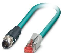
Câble de réseau, Ethernet CAT5 (1 Gbit/s), 8-pôles, Type de câble variable, blindé, connecteur mâle droit M12 SPEEDCONNEC, détrompage: A / IP67, sur connecteur mâle droit RJ45 / IP20, longueur de câble: Longueur au choix (0,2... 40,0 m)
