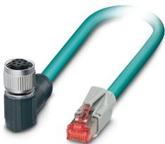
Câble de réseau, Ethernet CAT5 (1 Gbit/s), 8-pôles, Type de câble variable, blindé, Connecteur femelle coudé M12 SPEEDCONNec, détrompage: A / IP67, sur connecteur mâle droit RJ45 / IP20, longueur de câble: Longueur au choix (0,2... 40,0 m)
