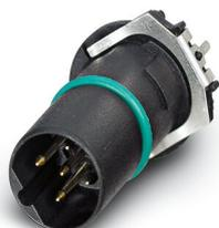
Connecteur mâle encastrable pour capteurs/actionneurs, 5 pôles, détrompage B, raccordement soudé THR droit, uniquement isolant pour contacts
