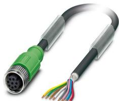
Câble pour capteurs/actionneurs, 8-pôles, blindé, extrémité libre, sur Connecteur femelle droit M12, détrompage: A, longueur de câble: 10 m
