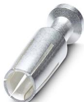
Contact à sertir, diamètre de contact: 4 mm, tournés, Connecteur femelle, matériau de contact: Alliage de cuivre, surface des contacts: plaqué argent, section raccordable: 4 mm<sup>2</sup> ... 4 mm<sup>2</sup>, AWG 12
