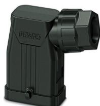
Capot passe-câble COM, pour étrier longitudinal, matériau: PA, nombre de sorties: 1, latérale, 1x M25, hauteur: 84 mm, presse-étoupe: avec, Standard
