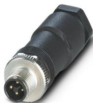
Connecteur de puissance, Puissance, 4-pôles, non blindé, connecteur mâle droit M12, T, Raccordement vissé, matériau de la molette: Zinc moulé sous pression, nickelé, presse-étoupe Pg11, diamètre extérieur du câble 8 mm ... 10 mm, pour courant continu jusqu'à 12 A/63 V, Contact 4 à fermeture
