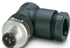
Connecteur de puissance, 4-pôles, non blindé, connecteur mâle coudé M12, T, Raccordement vissé, matériau de la molette: Zinc moulé sous pression, nickelé, presse-étoupe Pg11, diamètre extérieur du câble 8 mm ... 10 mm, pour courant continu jusqu'à 12 A/63 V, Contact 4 à fermeture
