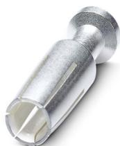
Contact à sertir, diamètre de contact: 4 mm, tournés, Connecteur femelle, matériau de contact: Alliage de cuivre, surface des contacts: plaqué argent, section raccordable: 6 mm<sup>2</sup> ... 6 mm<sup>2</sup>, AWG 10
