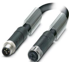
Conducteur de puissance, 4-pôles exempt d'halogène, connecteur mâle droit M12, détrompage: T, sur Connecteur femelle droit M12, détrompage: T, longueur de câble: 1 m, pour courant continu jusqu'à 12 A/63 V
