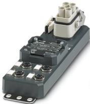
Répartiteur de puissance, application : Alimentation en énergie, type de raccordement: Connecteur femelle M12 Métal, nombre de prises: 4, nombre de pôles: 4, détrompage: T, affectation des prises: simple, affichage d'état: Oui, Universel; racc. câble multicond.: raccordement de câble principal enfichable 90°, blindage: non
