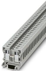
Bloc de jonction miniature, tension nominale: 250 V, intensité nominale: 24 A, nombre de connexions: 2, type de raccordement: Raccordement vissé, 1er étage, Section de référence: 2,5 mm<sup>2</sup>, section : 0,2 mm<sup>2</sup> - 2,5 mm<sup>2</sup>, type de montage: NS 15, coloris: gris
