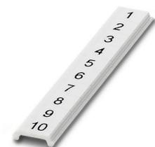
Ruban de repérage ZB, plat, Rubans, blanc, repéré, impression transversale: numérotation continue 1 ... 10, 11 ... 20, etc. jusqu'à 91 ... 100, type de montage: encliquetage, pour bloc de jonction au pas de : 4 mm, surface utile: 4,2 x 5,2 mm, Nombre d'étiquettes: 10
