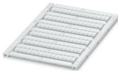
Repères pour blocs de jonction, à commander : sous forme de planche, blanc, impression selon les indications du client, type de montage: encliquetage dans la rainure de repérage plate, pour bloc de jonction au pas de : 4,2 mm, surface utile: 3,4 x 4,7 mm, Nombre d'étiquettes: 90
