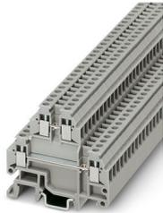
Micro-bloc, tension nominale: 400 V, intensité nominale: 17,5 A, type de raccordement: Raccordement vissé, 1er et 2e étage, Section de référence: 1,5 mm<sup>2</sup>, section : 0,14 mm<sup>2</sup> - 1,5 mm<sup>2</sup>, type de montage: NS 15, NS 35/7,5, NS 35/15, coloris: gris
