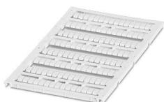
Repères pour blocs de jonction, à commander : sous forme de planche, blanc, impression selon les indications du client, type de montage: encliquetage dans la rainure de repérage plate, pour bloc de jonction au pas de : 4,2 mm, surface utile: 3,6 x 5,1 mm, Nombre d'étiquettes: 120
