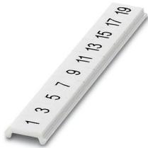
Ruban de repérage ZB, plat, Rubans, blanc, repéré, impression longitudinale: numérotation impaire 1-19, 21-39, etc. jusqu'à 81-99, type de montage: encliquetage, pour bloc de jonction au pas de : 4 mm, surface utile: 5,15 x 4,15 mm, Nombre d'étiquettes: 10
