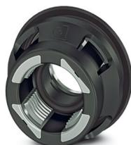
Raccordement vissé de boîtier M12 avec fonction de compensation des tolérances pour éléments de contacts de douilles M12 droits compatibles THR. Adapté aux panneaux avant de 2,4 mm ... 3,2 mm d'épaisseur.
