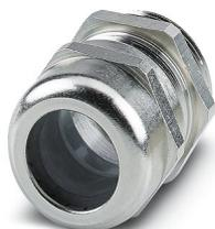
Presse-étoupe, matériau du raccordement vissé: Laiton, nickelé, diamètre extérieur du câble 18 mm ... 25 mm, blindage: non, filetage de raccordement: M40 x 1,5, coloris: argenté, avec joint torique
