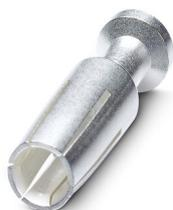
Contact à sertir, diamètre de contact: 4 mm, tournés, Connecteur femelle, matériau de contact: Alliage de cuivre, sans plomb, surface des contacts: plaqué argent, section raccordable: 1,5 mm<sup>2</sup> ... 1,5 mm<sup>2</sup>, AWG 16
