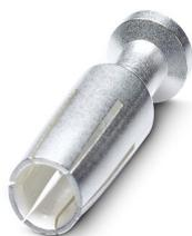
Contact à sertir, diamètre de contact: 4 mm, tournés, Connecteur femelle, matériau de contact: Alliage de cuivre, sans plomb, surface des contacts: plaqué argent, section raccordable: 4 mm<sup>2</sup> ... 4 mm<sup>2</sup>, AWG 12
