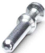
Contact à sertir, diamètre de contact: 4 mm, tournés, Mâle, matériau de contact: Alliage de cuivre, surface des contacts: plaqué argent, section raccordable: 10 mm<sup>2</sup> ... 10 mm<sup>2</sup>, AWG 8
