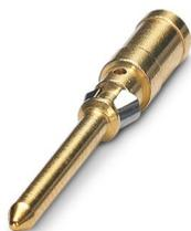
Contact à sertir, diamètre de contact: 1,6 mm, tournés, Mâle, matériau de contact: Alliage de cuivre, surface des contacts: doré, section raccordable: 2,5 mm<sup>2</sup> ... 2,5 mm<sup>2</sup>, AWG 14
