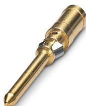
Contact à sertir, diamètre de contact: 1,6 mm, tournés, Mâle, matériau de contact: Alliage de cuivre, surface des contacts: doré, section raccordable: 0,14 mm<sup>2</sup> ... 0,37 mm<sup>2</sup>, AWG 22 ... 24
