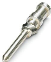
Contact à sertir, diamètre de contact: 1,6 mm, tournés, Mâle, matériau de contact: Alliage de cuivre, surface des contacts: plaqué argent, section raccordable: 2,5 mm<sup>2</sup> ... 2,5 mm<sup>2</sup>, AWG 14
