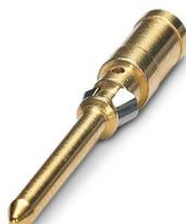
Contact à sertir, diamètre de contact: 1,6 mm, tournés, Mâle, matériau de contact: Alliage de cuivre, surface des contacts: doré, section raccordable: 1 mm<sup>2</sup> ... 1 mm<sup>2</sup>, AWG 18
