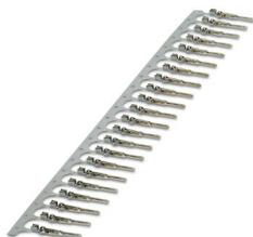
Contact à sertir, diamètre de contact: 1,6 mm, roulés, Mâle, matériau de contact: Alliage Cu, nickelé, surface des contacts: plaqué argent, section raccordable: 0,34 mm<sup>2</sup> ... 1 mm<sup>2</sup>, AWG 22 ... 17, Produits en bande
