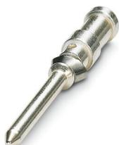
Contact à sertir, diamètre de contact: 1,6 mm, tournés, Mâle, matériau de contact: Alliage de cuivre, surface des contacts: plaqué argent, section raccordable: 0,75 mm<sup>2</sup> ... 0,75 mm<sup>2</sup>, AWG 18
