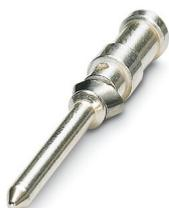
Contact à sertir, diamètre de contact: 1,6 mm, tournés, Mâle, matériau de contact: Alliage de cuivre, sans plomb, surface des contacts: plaqué argent, section raccordable: 1 mm<sup>2</sup> ... 1 mm<sup>2</sup>, AWG 18
