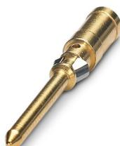
Contact à sertir, diamètre de contact: 1,6 mm, tournés, Mâle, matériau de contact: Alliage de cuivre, surface des contacts: doré, section raccordable: 0,75 mm<sup>2</sup> ... 0,75 mm<sup>2</sup>, AWG 18
