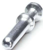
Contact à sertir, diamètre de contact: 4 mm, tournés, Mâle, matériau de contact: Alliage de cuivre, surface des contacts: plaqué argent, section raccordable: 6 mm<sup>2</sup> ... 6 mm<sup>2</sup>, AWG 10
