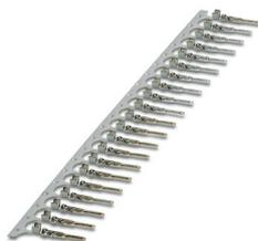
Contact à sertir, diamètre de contact: 1,6 mm, roulés, Mâle, matériau de contact: Alliage Cu, nickelé, surface des contacts: plaqué argent, section raccordable: 1,5 mm<sup>2</sup> ... 2,5 mm<sup>2</sup>, AWG 16 ... 14, Produits en bande
