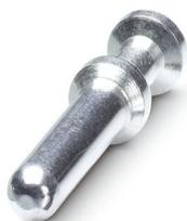
Contact à sertir, diamètre de contact: 4 mm, tournés, Mâle, matériau de contact: Alliage de cuivre, surface des contacts: plaqué argent, section raccordable: 2,5 mm<sup>2</sup> ... 2,5 mm<sup>2</sup>, AWG 14
