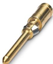
Contact à sertir, diamètre de contact: 1,6 mm, tournés, Mâle, matériau de contact: Alliage de cuivre, surface des contacts: doré, section raccordable: 1,5 mm<sup>2</sup> ... 1,5 mm<sup>2</sup>, AWG 16
