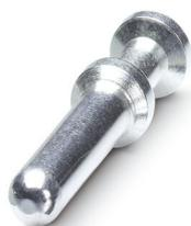
Contact à sertir, diamètre de contact: 4 mm, tournés, Mâle, matériau de contact: Alliage de cuivre, surface des contacts: plaqué argent, section raccordable: 4 mm<sup>2</sup> ... 4 mm<sup>2</sup>, AWG 12
