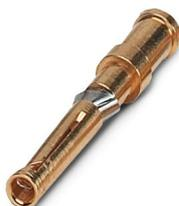
Contact à sertir, diamètre de contact: 1,6 mm, tournés, Connecteur femelle, matériau de contact: Alliage de cuivre, surface des contacts: doré, section raccordable: 0,14 mm<sup>2</sup> ... 0,37 mm<sup>2</sup>, AWG 24 ... 22
