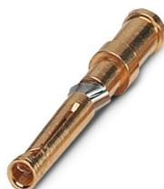
Contact à sertir, diamètre de contact: 1,6 mm, tournés, Connecteur femelle, matériau de contact: Alliage de cuivre, surface des contacts: doré, section raccordable: 2,5 mm<sup>2</sup> ... 2,5 mm<sup>2</sup>, AWG 14
