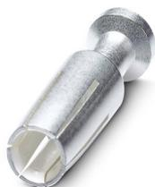
Contact à sertir, diamètre de contact: 4 mm, tournés, Connecteur femelle, matériau de contact: Alliage de cuivre, surface des contacts: plaqué argent, section raccordable: 1,5 mm<sup>2</sup> ... 1,5 mm<sup>2</sup>, AWG 16
