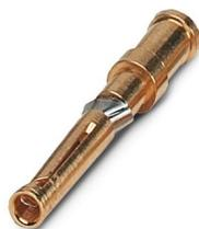
Contact à sertir, diamètre de contact: 1,6 mm, tournés, Connecteur femelle, matériau de contact: Alliage de cuivre, surface des contacts: doré, section raccordable: 1,5 mm<sup>2</sup> ... 1,5 mm<sup>2</sup>, AWG 16
