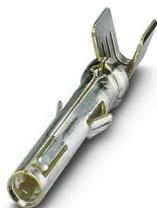
Contact à sertir, diamètre de contact: 1,6 mm, roulés, Connecteur femelle, matériau de contact: Alliage Cu, nickelé, surface des contacts: plaqué argent, section raccordable: 1,5 mm<sup>2</sup> ... 2,5 mm<sup>2</sup>, AWG 16 ... 14
