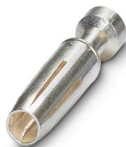
Contact à sertir, diamètre de contact: 2,5 mm, tournés, Connecteur femelle, matériau de contact: Alliage de cuivre, sans plomb, surface des contacts: plaqué argent, section raccordable: 4 mm<sup>2</sup> ... 4 mm<sup>2</sup>, AWG 12
