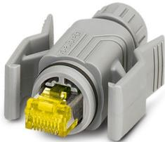
Connecteur RJ45, type: RJ45, indice de protection: IP67, nombre de pôles: 2, 10 Gbit/s, CAT6<sub>A</sub>, matériau: Plastique, type de raccordement: Raccordement à sertir, section raccordable: AWG 24- 27, sortie du câble: droit, coloris: gris, Ethernet / PROFINET
