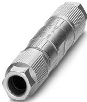
Prolongateur de câble, Ethernet, CAT5 (100 MBit/s), 4 pôles, exempt d'halogène, blindé, raccordement autodénudant, matière du boîtier : zinc moulé, nickelé, diamètre extérieur du câble de 5 mm à 9,7 mm 9,7 mm
