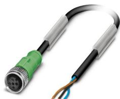
Câble pour capteurs/actionneurs, 3-pôles, extrémité libre, sur Connecteur femelle droit M12, détrompage: A, longueur de câble: 1,5 m
