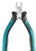
Pince coupante diagonale électronique, tête arrondie, sans chanfrein, avec ressort d'ouverture, poli miroir et huilée, poignée à 2 éléments, capacité de coupe : souple 0,2 - 2,0 mm ; dureté moyenne 1,2 mm ; dur 0,5 mm de diamètre
