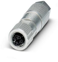
Connecteur de données, Ethernet CAT6<sub>A</sub> (10 Gbit/s), 8-pôles, exempt d'halogène, blindé, connecteur femelle droit M12, X, Raccordement autodénudant, matériau de la molette: Zinc moulé sous pression, nickelé, diamètre extérieur du câble 5 mm ... 9,7 mm
