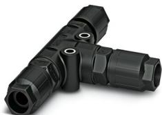
Répartiteur en T, Raccordement QUICKON, nombre de pôles: 3+PE, 690 V, 17,5 A, noir, avec 3 écrous QUICKON, diamètre extérieur du câble: 5 mm ... 9,5 mm
