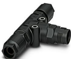
Répartiteur en T, Raccordement QUICKON, nombre de pôles: 3+PE, 690 V, 17,5 A, noir, avec deux écrous QUICKON, diamètre extérieur du câble: 5 mm ... 9,5 mm
