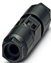
Prolongateur de câble, Raccordement QUICKON, nombre de pôles: 3+PE, 690 V, 17,5 A, noir, avec deux écrous QUICKON, diamètre extérieur du câble: 5 mm ... 9,5 mm, Connecteur QUICKON
