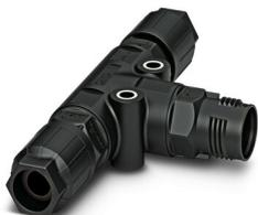
Répartiteur en T, Raccordement QUICKON, nombre de pôles: 3+PE, 690 V, 17,5 A, noir, avec deux écrous QUICKON, diamètre extérieur du câble: 5 mm ... 9,5 mm
