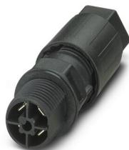
Traversée de paroi, Raccordement QUICKON, nombre de pôles: 3+PE, 690 V, 15 A, noir, avec écrou QUICKON, diamètre extérieur du câble: 5 mm ... 9,5 mm, filetage de montage: M20, Raccordement par clips (pour clips selon DIN 46247-2), 1,5 mm<sup>2</sup>
