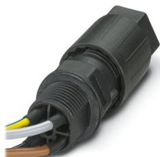
Traversée de paroi, Raccordement QUICKON, nombre de pôles: 3+PE, 690 V, 17,5 A, noir, avec écrou QUICKON, diamètre extérieur du câble: 5 mm ... 9,5 mm, filetage de montage: M20, Fils individuels, 1,5 mm<sup>2</sup>, longueur du câble: 1 m
