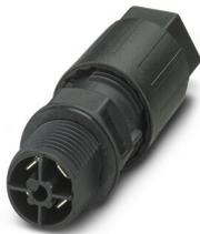
Traversée de paroi, Raccordement QUICKON, nombre de pôles: 3+PE, 690 V, 15 A, noir, avec écrou QUICKON, diamètre extérieur du câble: 10 mm ... 13 mm, filetage de montage: M20, Raccordement par clips (pour clips selon DIN 46247-2), 1,5 mm<sup>2</sup>
