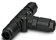
Répartiteur en T, Raccordement QUICKON, nombre de pôles: 3+PE, 690 V, 17,5 A, noir, avec 3 écrous QUICKON, diamètre extérieur du câble: 10 mm ... 13 mm
