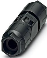
Prolongateur de câble, Raccordement QUICKON, nombre de pôles: 3+PE, 690 V, 17,5 A, noir, avec deux écrous QUICKON, diamètre extérieur du câble: 10 mm ... 13 mm, Connecteur QUICKON
