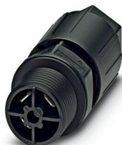
Traversée de paroi, Raccordement QUICKON, nombre de pôles: 2+PE, 690 V, 15 A, noir, avec écrou QUICKON, diamètre extérieur du câble: 10 mm ... 13 mm, filetage de montage: M20, Raccordement par clips (pour clips selon DIN 46247-2), 1,5 mm<sup>2</sup>
