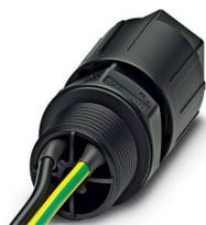
Traversée de paroi, Raccordement QUICKON, nombre de pôles: 2+PE, 690 V, 17,5 A, noir, avec écrou QUICKON, diamètre extérieur du câble: 10 mm ... 13 mm, filetage de montage: M20, Fils individuels, 1,5 mm<sup>2</sup>, longueur du câble: 1 m
