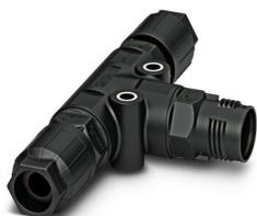
Répartiteur en T, Raccordement QUICKON, nombre de pôles: 2+PE, 690 V, 17,5 A, noir, avec deux écrous QUICKON, diamètre extérieur du câble: 10 mm ... 13 mm
