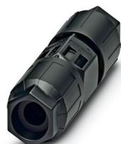
Prolongateur de câble, Raccordement QUICKON, nombre de pôles: 2+PE, 690 V, 17,5 A, noir, avec deux écrous QUICKON, diamètre extérieur du câble: 10 mm ... 13 mm, Connecteur QUICKON
