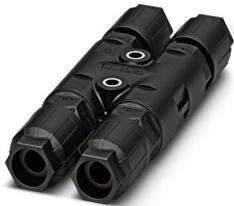
Répartiteur en H, Raccordement QUICKON, nombre de pôles: 2+PE, 690 V, 17,5 A, noir, avec quatre écrous QUICKON, diamètre extérieur du câble: 10 mm ... 13 mm, avec un boulon de fermeture
