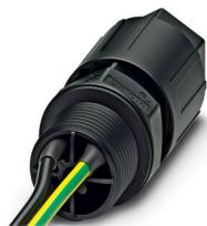
Traversée de paroi, Raccordement QUICKON, nombre de pôles: 2+PE, 690 V, 17,5 A, noir, avec écrou QUICKON, diamètre extérieur du câble: 10 mm ... 13 mm, filetage de montage: M20, Fils individuels, 1,5 mm<sup>2</sup>, longueur du câble: 0,5 m
