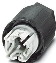
Ecrou, Raccordement QUICKON, nombre de pôles: 2+PE, 690 V, 17,5 A, noir, diamètre extérieur du câble: 10 mm ... 13 mm
