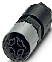
Connecteur, Raccordement QUICKON, nombre de pôles: 3+PE, 690 V, 17,5 A, noir, avec écrou QUICKON, diamètre extérieur du câble: 5 mm ... 9,5 mm
