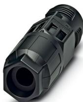
Prolongateur de câble, Raccordement QUICKON, nombre de pôles: 3+PE, 690 V, 17,5 A, noir, avec un écrou QUICKON, diamètre extérieur du câble: 5 mm ... 9,5 mm, Connecteur QUICKON
