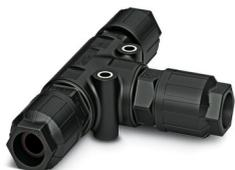
Répartiteur en T, Raccordement QUICKON, nombre de pôles: 4+PE, 690 V, 17,5 A, noir, avec 3 écrous QUICKON, diamètre extérieur du câble: 6 mm ... 10 mm
