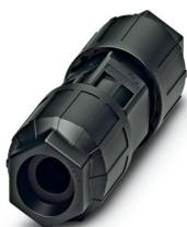
Prolongateur de câble, Raccordement QUICKON, nombre de pôles: 4+PE, 690 V, 17,5 A, noir, avec deux écrous QUICKON, diamètre extérieur du câble: 6 mm ... 10 mm, Connecteur QUICKON
