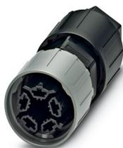
Connecteur, Raccordement QUICKON, nombre de pôles: 4+PE, 690 V, 17,5 A, noir, avec écrou QUICKON, diamètre extérieur du câble: 6 mm ... 10 mm
