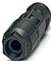
Prolongateur de câble, Raccordement QUICKON, nombre de pôles: 4+PE, 690 V, 17,5 A, noir, avec un écrou QUICKON, diamètre extérieur du câble: 6 mm ... 10 mm, Connecteur QUICKON
