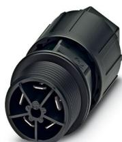
Traversée de paroi, Raccordement QUICKON, nombre de pôles: 4+PE, 690 V, 17,5 A, noir, avec écrou QUICKON, diamètre extérieur du câble: 6 mm ... 10 mm, filetage de montage: M25, Raccordement par clips (pour clips selon DIN 46247-2), 1,5 mm<sup>2</sup>
