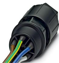
Traversée de paroi, Raccordement QUICKON, nombre de pôles: 4+PE, 690 V, 17,5 A, noir, avec écrou QUICKON, diamètre extérieur du câble: 6 mm ... 10 mm, filetage de montage: M25, Fils individuels, 1,5 mm<sup>2</sup>, longueur du câble: 0,5 m
