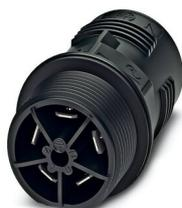
Traversée de paroi, Raccordement QUICKON, nombre de pôles: 4+PE, 690 V, 17,5 A, noir, sans écrou QUICKON, filetage de montage: M25, Raccordement par clips (pour clips selon DIN 46247-2), 1,5 mm<sup>2</sup>
