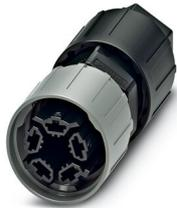
Connecteur, Raccordement QUICKON, nombre de pôles: 4+PE, 690 V, 17,5 A, noir, avec écrou QUICKON, diamètre extérieur du câble: 6 mm ... 10 mm
