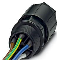
Traversée de paroi, Raccordement QUICKON, nombre de pôles: 4+PE, 690 V, 17,5 A, noir, avec écrou QUICKON, diamètre extérieur du câble: 6 mm ... 10 mm, filetage de montage: M25, Fils individuels, 1,5 mm<sup>2</sup>, longueur du câble: 1 m
