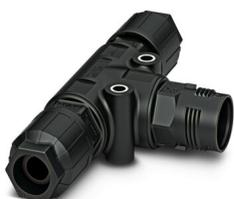
Répartiteur en T, Raccordement QUICKON, nombre de pôles: 4+PE, 690 V, 17,5 A, noir, avec deux écrous QUICKON, diamètre extérieur du câble: 6 mm ... 10 mm
