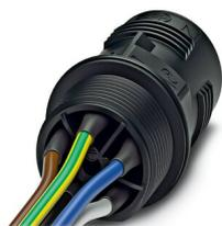
Traversée de paroi, Raccordement QUICKON, nombre de pôles: 4+PE, 690 V, 17,5 A, noir, sans écrou QUICKON, filetage de montage: M25, Fils individuels (soudé), 1,5 mm<sup>2</sup>, fils coupés nets, longueur du câble: 0,5 m
