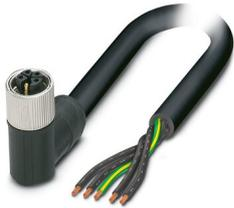
Conducteur de puissance, 5-pôles exempt d'halogène, extrémité libre, sur Connecteur femelle coudé M12, détrompage: K, longueur de câble: 5 m, pour courant alternatif jusque 16 A/690 V
