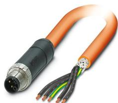
Conducteur de puissance, 5-pôles exempt d'halogène, blindé (Advanced Shielding Technology), connecteur mâle droit M12, détrompage: K, sur extrémité libre, longueur de câble: 10 m, pour courant alternatif jusqu'à 16 A/690 V
