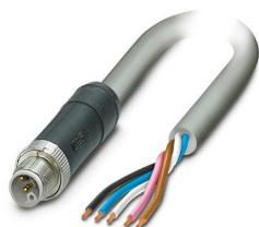
Conducteur de puissance, 5-pôles exempt d'halogène, connecteur mâle droit M12, détrompage: L, sur extrémité libre, longueur de câble: 1,5 m, pour courant continu jusque 16 A / 63 V
