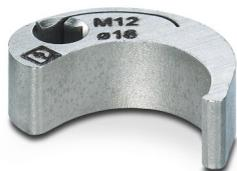
Embout pour le montage de câbles pour capteurs/actionneurs munis de connecteurs M12 et de connecteurs M12 à équiper avec diamètre d'écrou moleté de 16 mm, pour emmanchement à six pans de 4 mm
