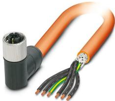
Conducteur de puissance, 6-pôles exempt d'halogène, blindé (Advanced Shielding Technology), extrémité libre, sur Connecteur femelle coudé M12, détrompage: M, longueur de câble: 3 m, pour courant alternatif jusqu'à 8 A/690 V
