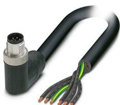
Conducteur de puissance, 6-pôles exempt d'halogène, connecteur mâle coudé M12, détrompage: M, sur extrémité libre, longueur de câble: 1,5 m, pour courant alternatif jusqu'à 8 A/690 V
