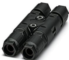
Répartiteur en H, Raccordement QUICKON, nombre de pôles: 3+PE, 690 V, 17,5 A, noir, avec quatre écrous QUICKON, diamètre extérieur du câble: 5 mm .. 9,5 mm, avec un boulon de fermeture
