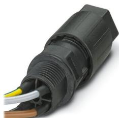
Traversée de paroi, Raccordement QUICKON, nombre de pôles: 3+PE, 690 V, 17,5 A, noir, avec écrou QUICKON, diamètre extérieur du câble: 5 mm ... 9,5 mm, filetage de montage: M20, Fils individuels, 1,5 mm<sup>2</sup>, longueur du câble: 0,5 m
