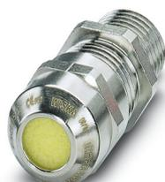
Presse-étoupe, matériau du raccordement vissé: Laiton, nickelé, application: Ex, diamètre extérieur du câble 5 mm ... 10 mm, blindage: oui, filetage de raccordement: M16 x 1,5, coloris: argenté, avec joint torique
