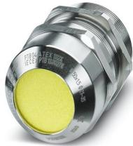
Presse-étoupe, matériau du raccordement vissé: Laiton, nickelé, application: Ex, diamètre extérieur du câble 21 mm ... 35 mm, blindage: oui, filetage de raccordement: M50 x 1,5, coloris: argenté, avec joint torique
