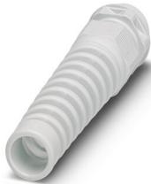
Presse-étoupe, matériau du raccordement vissé: PA, diamètre extérieur du câble 6 mm ... 13 mm, blindage: non, filetage de raccordement: M20 x 1,5, coloris: gris clair RAL 7035, avec protection anti-courbure
