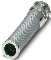
Presse-étoupe, matériau du raccordement vissé: Laiton, nickelé, diamètre extérieur du câble 13 mm ... 21 mm, blindage: non, filetage de raccordement: M32 x 1,5, coloris: argenté, avec protection anti-courbure, avec joint torique
