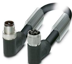
Conducteur de puissance, 4-pôles exempt d'halogène, blindé (Advanced Shielding Technology), connecteur mâle coudé M12, détrompage: T, sur Connecteur femelle coudé M12, détrompage: T, longueur de câble: 10 m, pour courant continu jusqu'à 12 A/63 V
