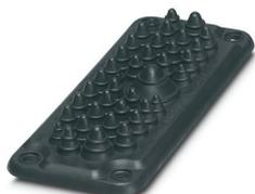
Plaques passe-câble, nombre de conducteurs: 37, diamètre extérieur du câble: 4x 6 mm ... 10 mm, 14x 8 mm ... 12 mm, 16x 10 mm ... 14 mm, 2x 12 mm ... 18 mm, 1x 17 mm ... 32 mm, matériau: Tôle d'acier galvanisé (matériel intérieur), matériau: TPE-SEBS (matériel extérieur), coloris: noir, longueur: 222 mm, largeur: 92 mm, hauteur: 29,5 mm
