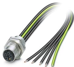
Connecteur d'appareil face arrière, Puissance, 5-pôles, connecteur femelle, droit, M12-Standard, détrompage: K, sur extrémité libre, Montage face arrière, M16 x 1,5, Cordons individuels, longueur de câble: 0,2 m, 2,50 mm<sup>2</sup>, Cordon PEX, Produit de remplacement selon RoHS II sans exception 6c (Pb < 0,1 %) référence : 1239081
