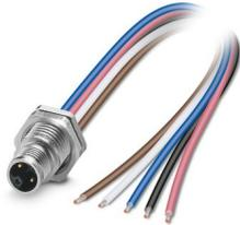
Connecteur d'appareil face arrière, Puissance, 5-pôles, Connecteur mâle, droit, M12-Standard, détrompage: L, sur extrémité libre, Montage face arrière, M16 x 1,5, Cordons individuels, longueur de câble: 0,2 m, 2,50 mm<sup>2</sup>, Cordon PEX, Produit de remplacement selon RoHS II sans exception 6c (Pb < 0,1 %) référence : 1239084
