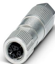
Connecteur de données, Ethernet CAT6<sub>A</sub> (10 Gbit/s), 8-pôles, exempt d'halogène, blindé, connecteur femelle droit M12, X, Raccordement autodénudant, matériau de la molette: Zinc moulé sous pression, nickelé, diamètre extérieur du câble 5 mm ... 9,7 mm
