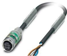
Câble pour capteurs/actionneurs, 4-pôles, extrémité libre, sur Connecteur femelle droit M12, détrompage: A, avec 2 LED, longueur de câble: 5 m
